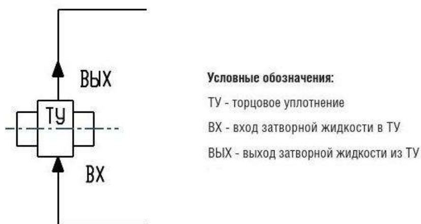
Рисунок 3 - Схема обвязки двойных торцовых уплотнений 52
